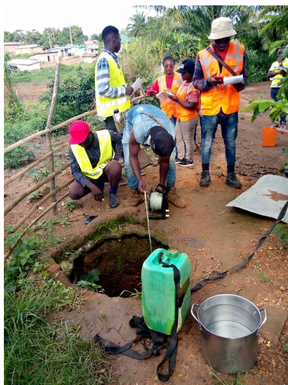
Figure 6: Pratique de la mesure du niveau d'eau dans un puits dans la sous-préfecture de Kouan-Houlé
